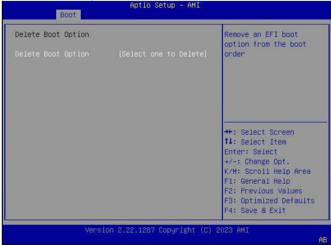
Şekil 3-143 Delete Boot Option Ekranı
