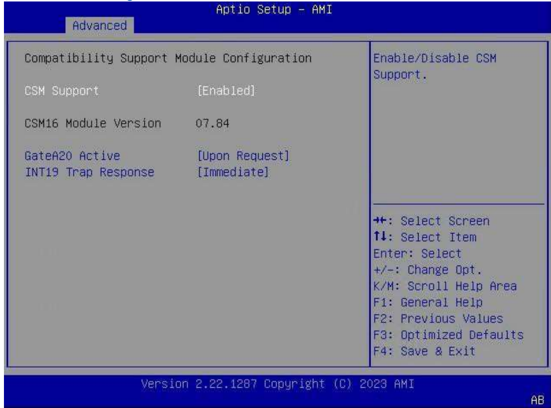
Şekil 3-25 CSM Configuration Ekranı
