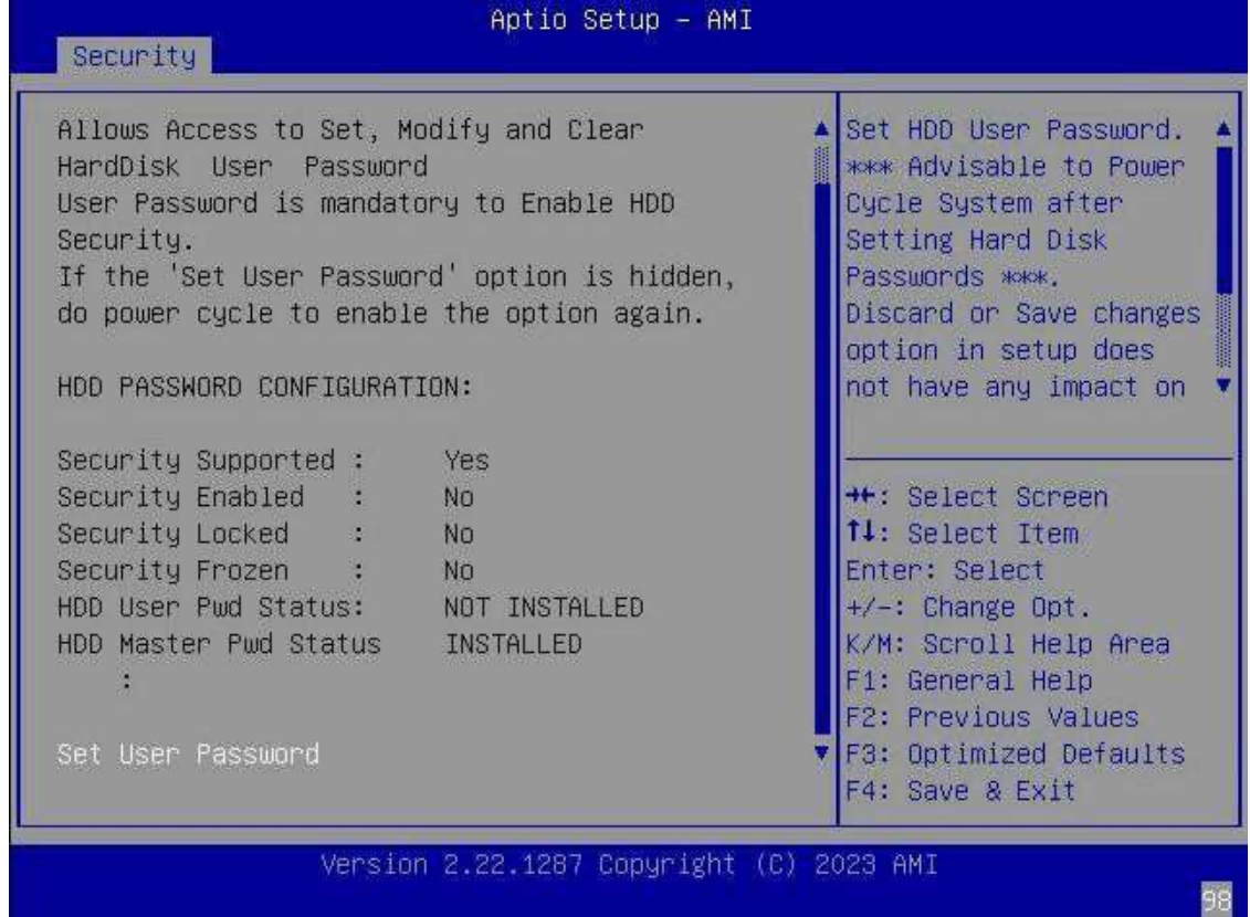
Şekil 3-136 HDD Security Configuration Ekranı
