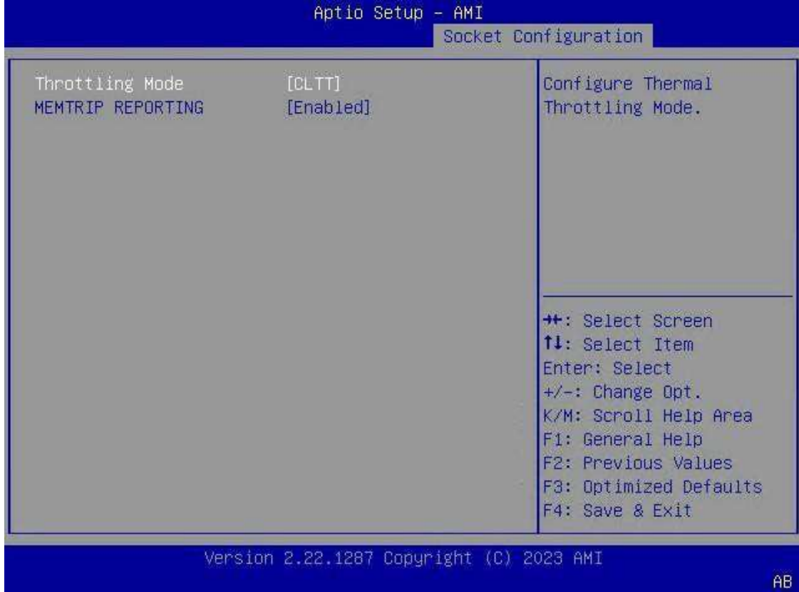
Şekil 3-116 Memory Thermal Ekranı
