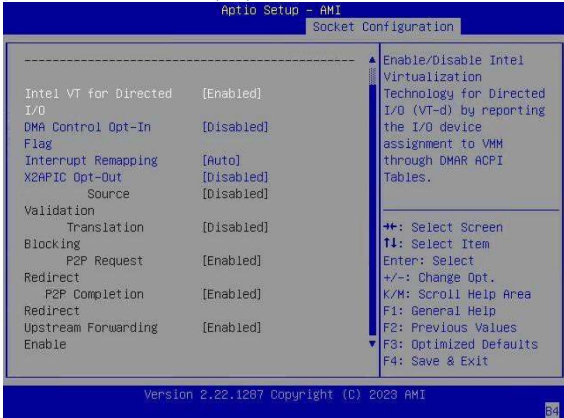
Şekil 3-100 Intel VT for Directed I/O (VT-d) Ekranı
