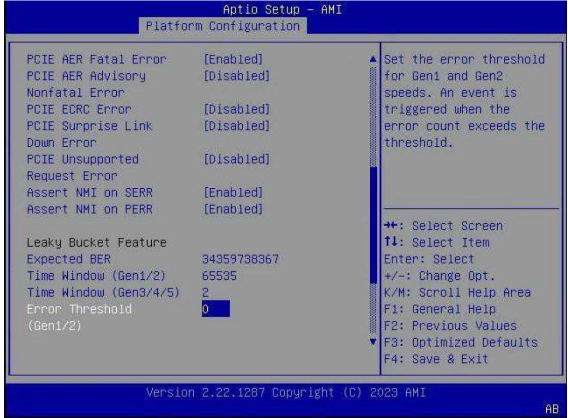
Şekil 3-61 PCIe Error Enabling Ekranı 3
