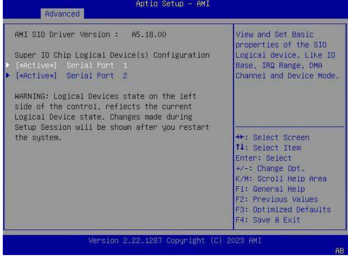
Şekil 3-19 SIO Configuration Ekranı
