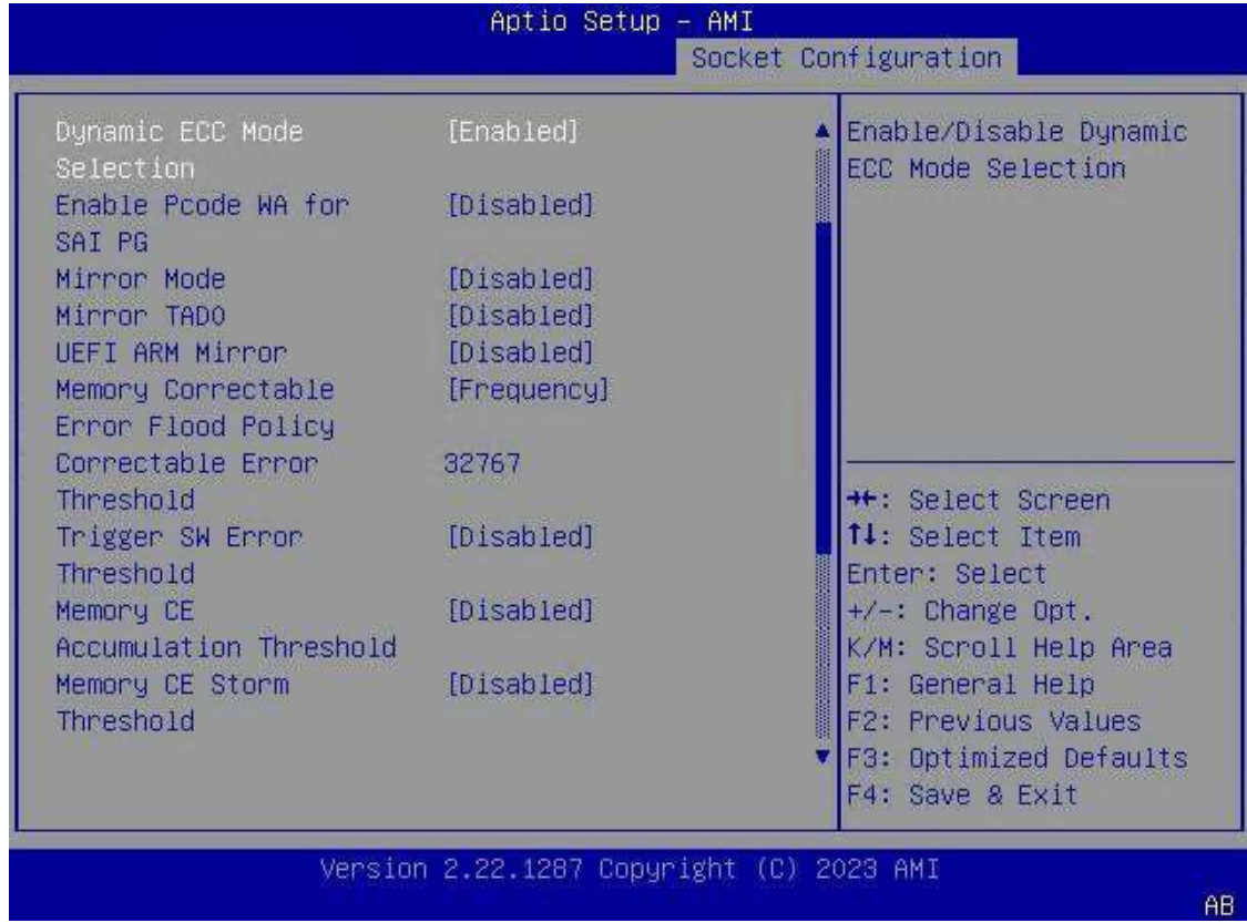
Şekil 3-91 Memory RAS Configuration Ekranı—2
