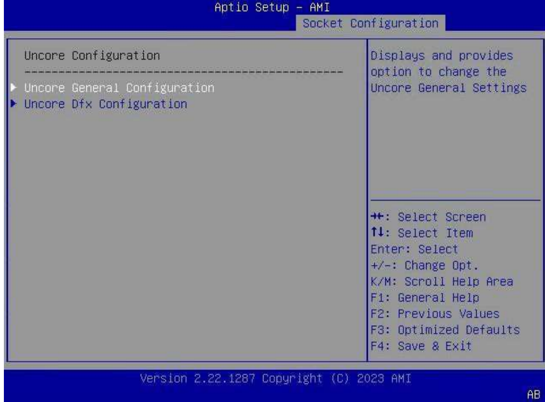
Şekil 3-72 Uncore Configuration Ekranı
