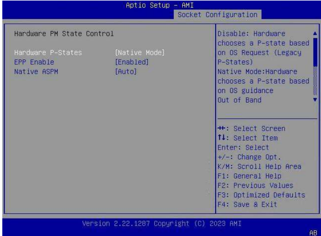
Şekil 3-105 Hardware PM State Control Ekranı
