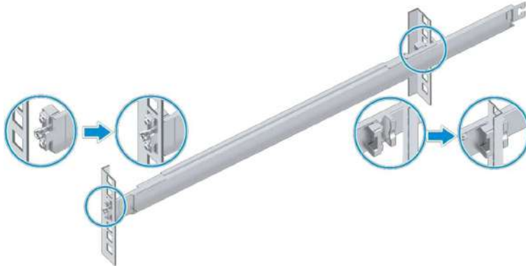
Şekil 6-3 Dış Rayların Takılması
